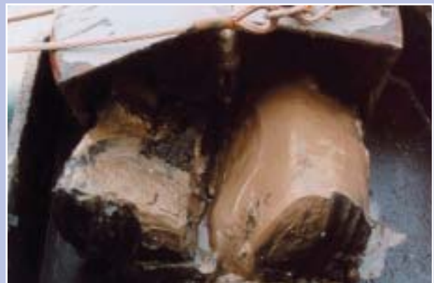
Slibrijk sediment bovengehaald met behulp van een Van Veen grijper. Een dergelijk sediment is kenmerkend voor de Paardenmarkt.
